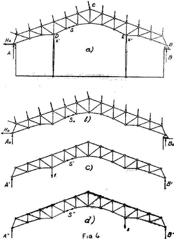
Suprimiendo los dos sostenes intermedios se obtiene la estructura principal estáticamente determinada, representada en la fig. 115 b, para la cual se saben determinar las reacciones  $A_0$ ,  $B_0$ ,  $H_0$  y los esfuerzos  $S^0$  de las barras, construyendo un diagrama recíproco.
